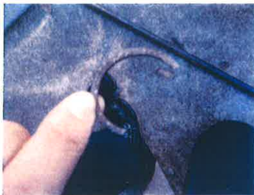
写真 5: 折損した C 型止め輪
