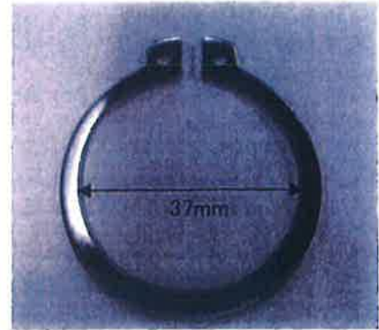
写真 4: 正常な C 型止め輪 (Φ40 軸用)
